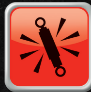
Cassé intérieurement ou bloqué en position repliée
